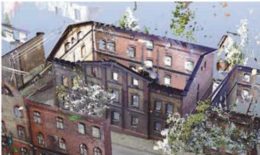
Rys. 4. Widok 3D zarejestrowanych skanów budynku mieszkalnego
