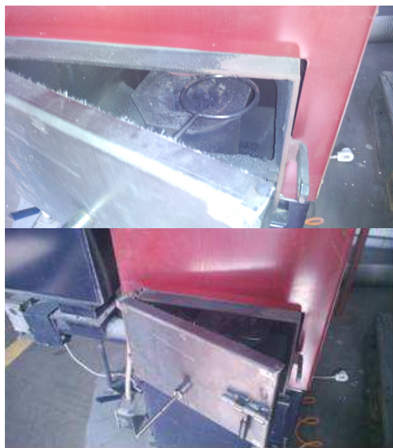
Rys. 2. Modyfikacje w kotle - doprowadzenie dodatkowego paliwa
