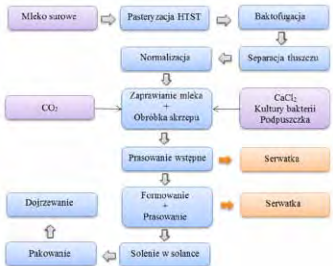
Rys. 1. Schemat blokowy produkcji półtwardych serów podpuszczkowych w zakładzie przetwórstwa mleczarskiego.
