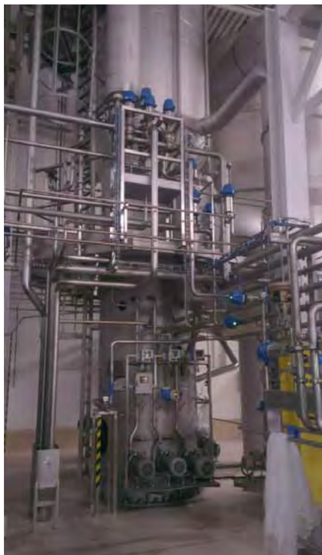
Rys. 9. Wyparka stosowana w zakładzie. Fig. 9. The evaporator used in the plant.
