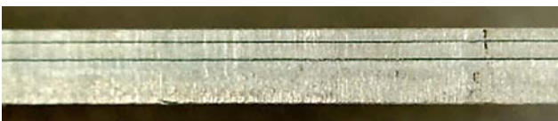
Rys. 2. Przekrój badanej próbki. Trzy warstwy aluminiowe połączone klejem epoksydowym
