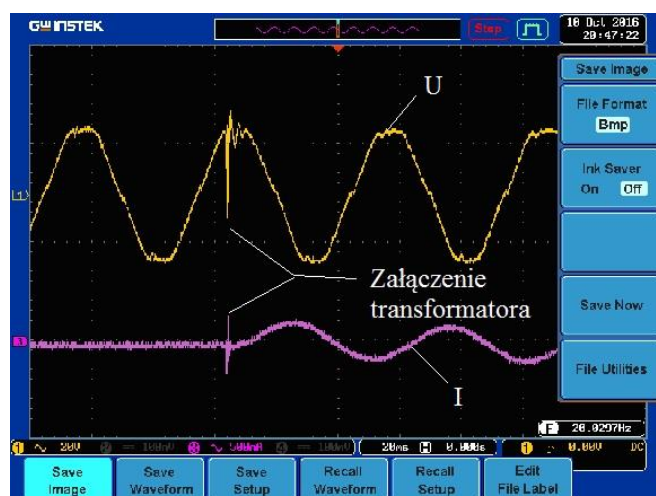
Rys. 8. Przebiegi wartości napięcia i prądu magnesującego przy załączeniu napięcia międzyfazowego o wartości równej 200 V
