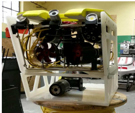
Rys. 3.14 Modułowy system do badania środowiska wodnego i obiektów podwodnych zbudowany przez firmę Forkos Sp. z o.o. w ramach projektu POIG.01.04.00-22-069/13 (system składa się z dwóch współpracujących ze sobą pojazdów podwodnych miniROV KH-200 i microROV Frog).
