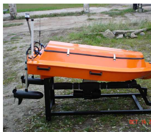
Rys. 3.9 Kadłub pojazdu USV Gambir podczas pierwszych prób w warunkach rzeczywistych.
