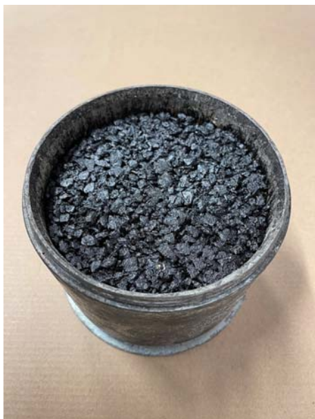
Fot. 3. Przykładowy widok próbki mieszanki mineralno-asfaltowej na zimno przygotowanej do badań gęstości objętościowej i odporności na deformacje trwałe
