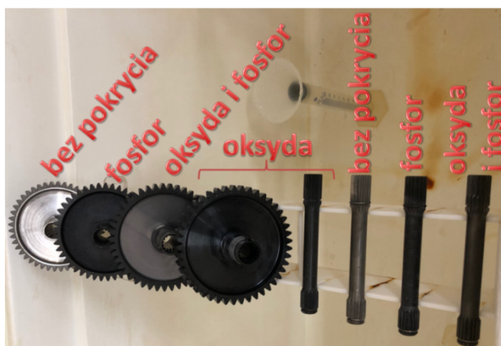
Rys. 1. Koła zębate i wałki skrętne przed rozpoczęciem badania korozyjnego metodą NSS
