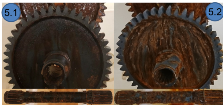
Rys. 5. Koło zębate i wałek skrętny z pokryciem fosforanowym po 120 h (5.1) i po 240 h (5.2) badania korozyjnego metodą NSS
