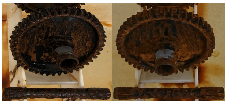
Rys. 3. Oksydowane koło zębate i wałek skrętny po 165 h (z lewej strony) i po 240 h (z prawej strony) badania korozyjnego metodą NSS
