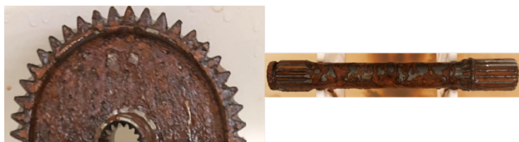
Rys. 2. Koło zębate i wałek skrętny bez żadnego pokrycia galwanicznego po 120 h badania korozyjnego metodą NSS
