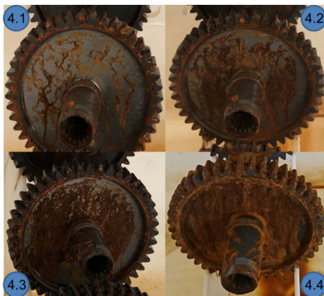
Rys. 4. Koło zębate z pokryciem oksydofosforanowym po 70 h (4.1); 120 h (4.2); 165 h (4.3) i 240 h (4.4) badania korozyjnego metodą NSS
