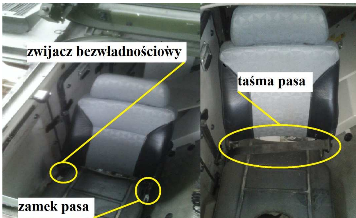
Rys. 1. Fotel kierowcy KTO Rosomak z widocznym dwupunktowym pasem bezpieczeństwa Źródło: opracowanie własne
