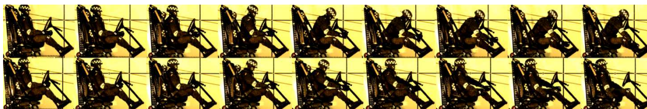
Rys. 8. Przemieszczenie manekina przypiętego pasem dwupunktowym (górze) oraz trzypunktowym (dół) od czasu 0 ms do 400 ms (prędkość 9,7 km/h, opóźnienie 5 g)
