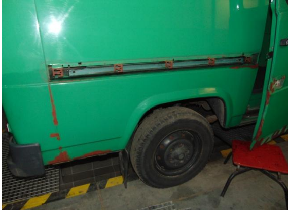
Fot. 11. Częściowa renowacja powłoki
