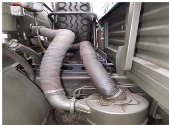
Fot. 10. Przewody filtra powietrza
