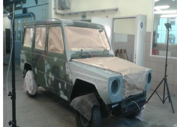
Fot. 13. Powłoka lakiernicza schnąca na powietrzu
