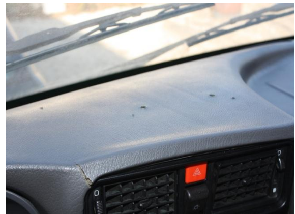
Fot. 6. Widok zużytej deski rozdzielczej
