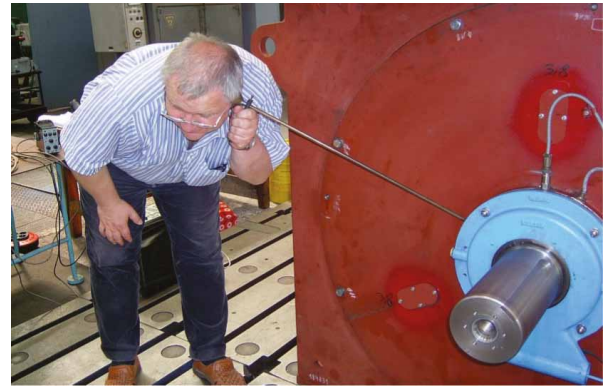
Rys. 17. Najprostszy sposób diagnozowania łożyska tocznego – osłuchanie łożyska przez jednego z autorów
