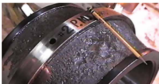
Rys. 19. Łożysko toczne, którego awarię wykrył ekspert oraz specjalistyczna aparatura
