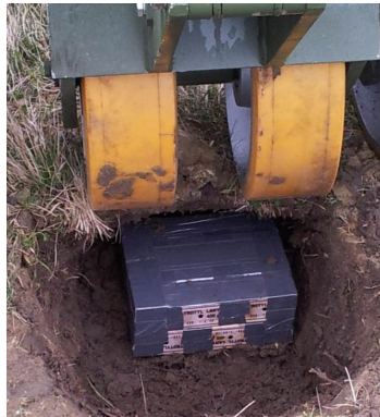
Rys. 6. Ładunek wybuchowy podłożony pod zestaw kołowy trału
