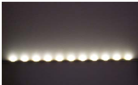
Rys. 9. Widok ściany oświetlonej LEDami oddalonymi o 10 cm od siebie i o 1 cm od ściany
