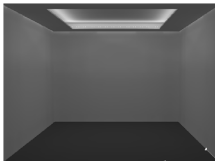
Rys. 8. Przykład wykonanej w programie Dialux wizualizacji instalacji oświetlenia pośredniego z LEDami świecącymi do środka pomieszczenia
