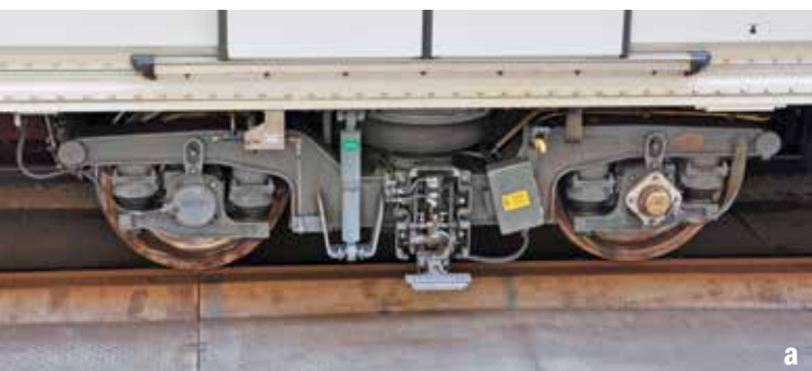
Pociąg Metropolis: a) wózek i odbierak prądu, b) na stacji Pillangó utca, linia Czerwona (19.06.2014 r.).
