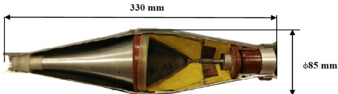
Rys. 1. Głowica kumulacyjna PG-7W (WITU)
