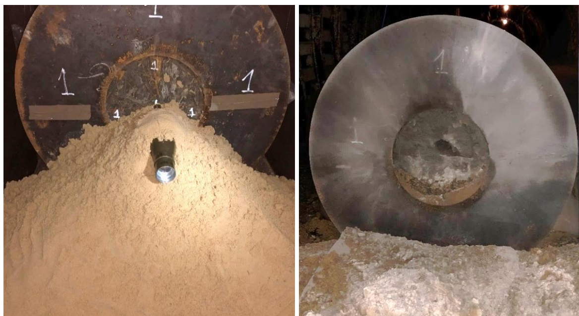
Rys. 7. Widok bloku cementowego w obudowie stalowej z przyłożoną głowicą kumulacyjną (po lewej) oraz jego powierzchni czołowej po detonacji ładunku kumulacyjnego (fot. GIG)
