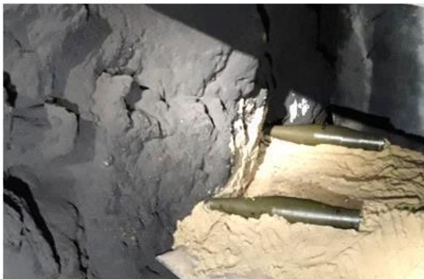
Rys. 11. Widok ściany i dwóch głowic kumulacyjnych PG-7WM przygotowanych do jednoczesnego odpalenia (fot. M. Magier)
