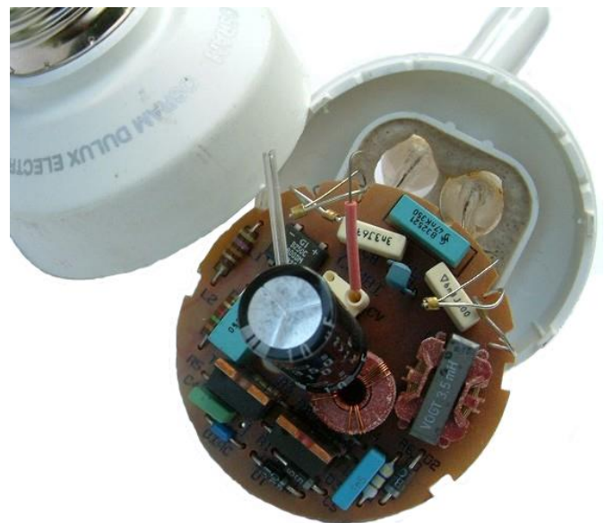
Rys. 7. Przykładowy indywidualny układ zapłonowy świetlówek kompaktowej
