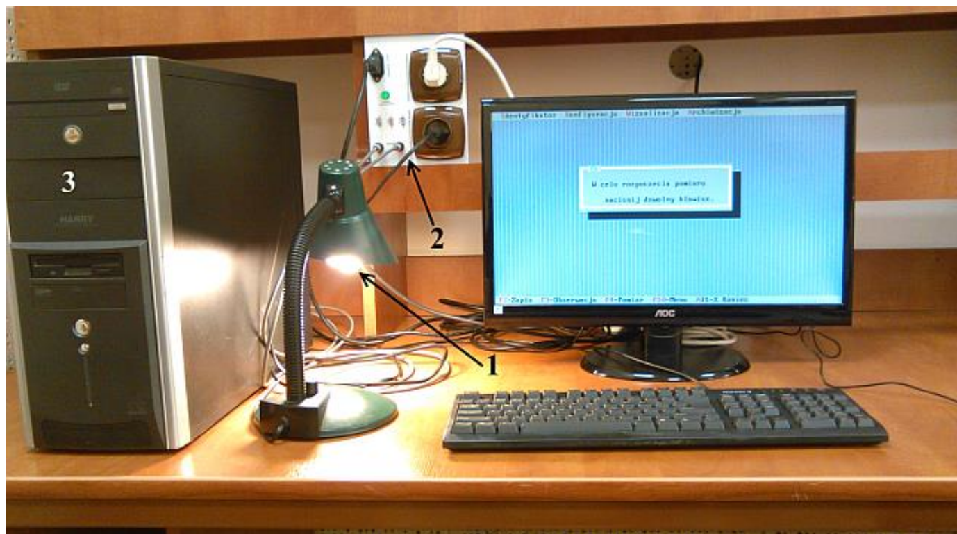
Rys. 8. Stanowisko do pomiaru mocy nowoczesnych źródeł światła, 1 – badane źródło światła, 2 – tablica pomiarowa stanowiska, 3 - komputer pomiarowy
