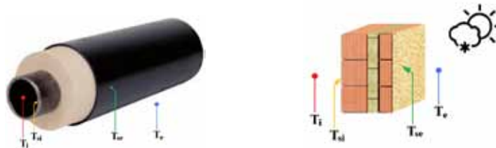
Rys. 1. Temperatuzy przyjmowane do obliczeń strumienia ciepła w izolowanym rurociągu oraz dla przegrody budowlanej
