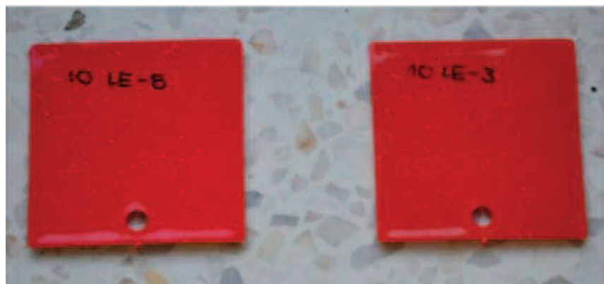
Rys.2. Próbkę barwne RAL 3020 o założonej odporności na UV w skali LE równej 8 (po lewej) i 3 (po prawej)
