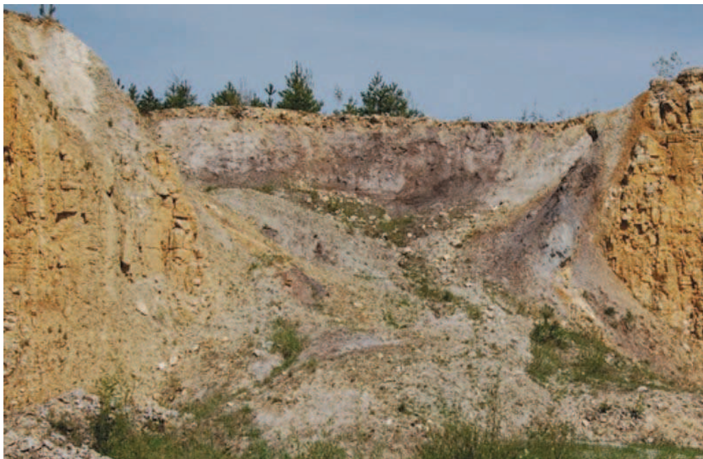
Rys. 2. Przykład osuwiska powstałego przez kras w kopalni wapienia Fig. 2. Example of the land slide formed by karst in limestone mine
