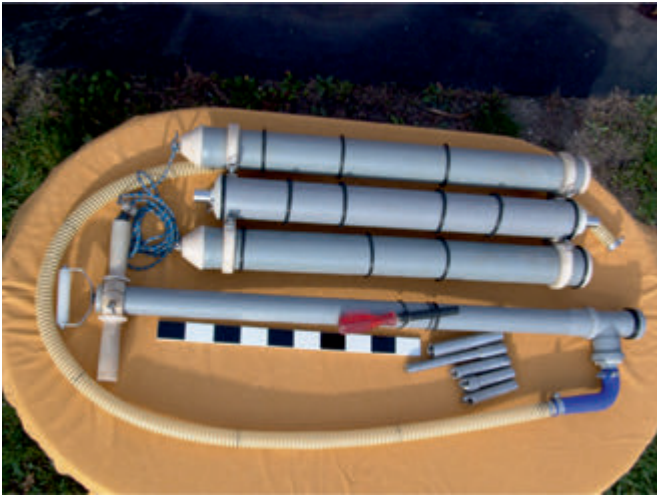
Rys. 3. Mobilny koncentrator grawitacyjny (MKG) z pompą Hendersona Fig. 3. Mobile gravity concentrator (MKG) with the Henderson's pump
