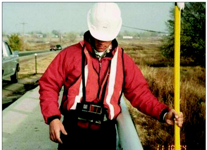
Fot. 1. Pomiar głębokości cieku przenośną sondą manualną wyposażoną w sonar, według [11]
