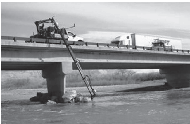
Fot. 2. Doprowadzanie sonaru do miejsca monitorowania z użyciem przegubowego wysięgnika żurawia zainstalowanego na ciężarówce, według [10]
