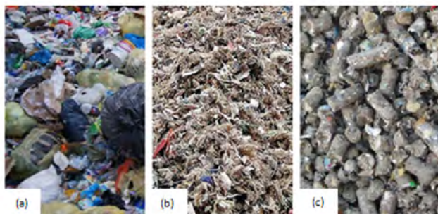
Rys. 4. Odpady komunalne (a), paliwo typu SRF (b), pelety z SRF (c)
