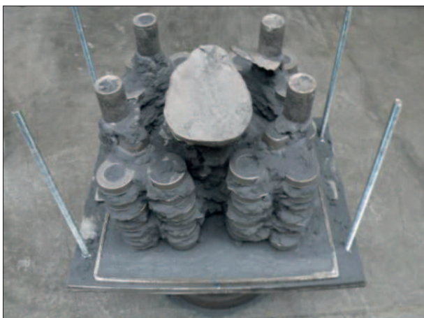
Rys. 13. Stos odlewów po częściowym rozbiciu formy, z wytopu odlanego do formy „monolitycznej”
