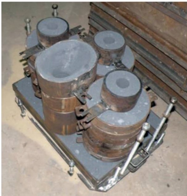
Rys. 10. Forma odlewnicza z trzema niezależnymi stosami Fig. 10. The mould with three independent stacks
