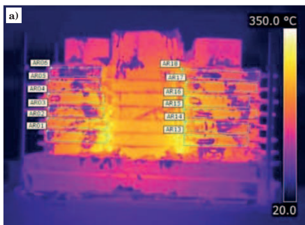
Rys. 12. Termogram obrazujący rozkład pola temperaturowego a) forma z trzema niezależnymi stosami, b) forma „monolityczna”
