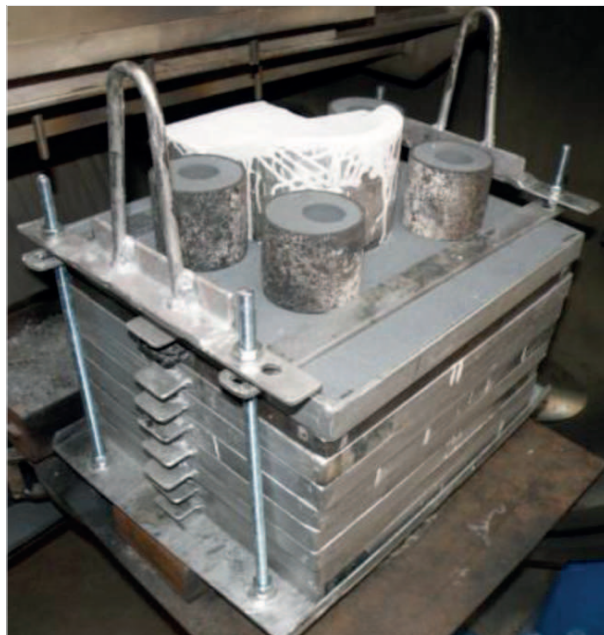
Rys. 11. Forma odlewnicza „monolityczna” Fig. 11. The “monolithic” mould
