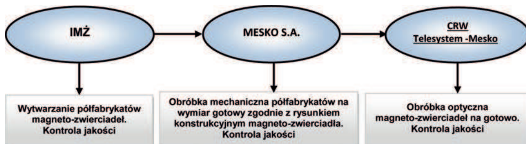
Rys. 23. Cykl technologiczny wytwarzania magneto-zwierciadeł
