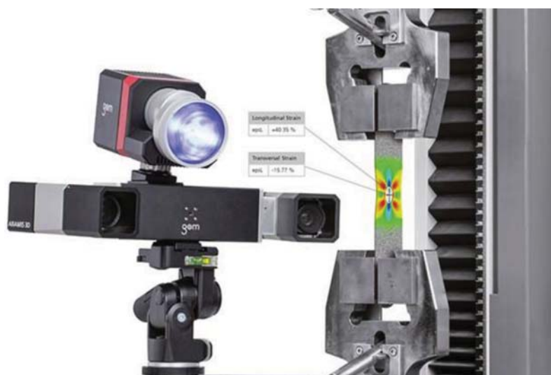
Rys. 1. Schemat systemu cyfrowej korelacji obrazu – system Aramis [13]
