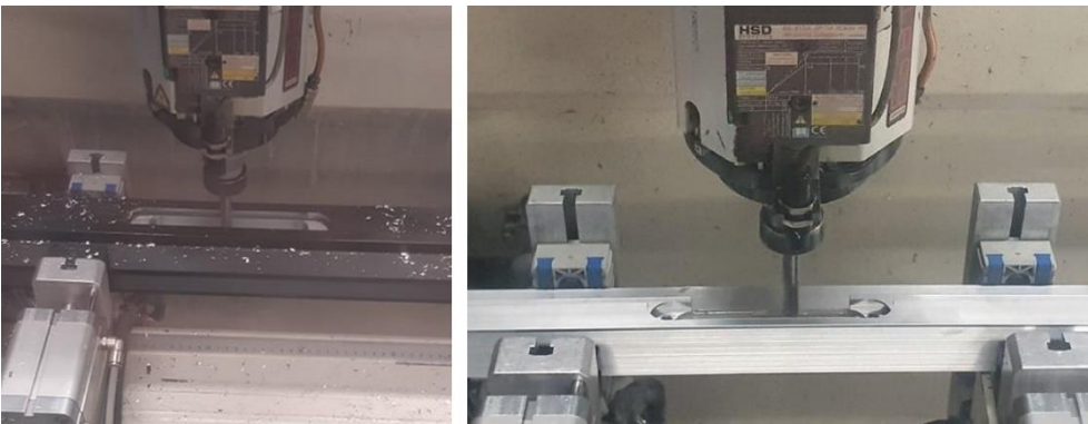
Fig. 6. Photos depicting the machining of the seats in the aluminium profiles (for PIU Glass frame profiles and slats with different finishes). Source: Photos from the collection of PIU Design Ryc. 6. Zdjęcia przedstawiające obróbkę gniazd w profilach aluminiowych (dla profili ościeżnic PIU Glass oraz listew w różnym wykończeniu). Źródło: Zdjęcia ze zbiorów firmy PIU Design
