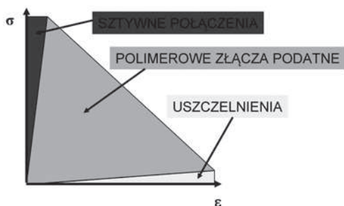
Rys. 3. Zakres pracy polimerowych złączy podatnych i charakterystyki budujących je poliuretanów Fig. 3. Polymer flexible joint range and characteristics of polyurethanes constructing them
