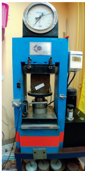
Rys. 4. Próbką w maszynie wytrzymałościowej
