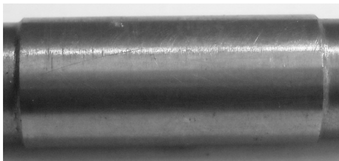
Rys. 8. Powierzchnia wałka stalowego smarowanego smarem Glacier po badaniach zmęczeniowych – brak zużycia frettingowego, pow. ok. 3×
