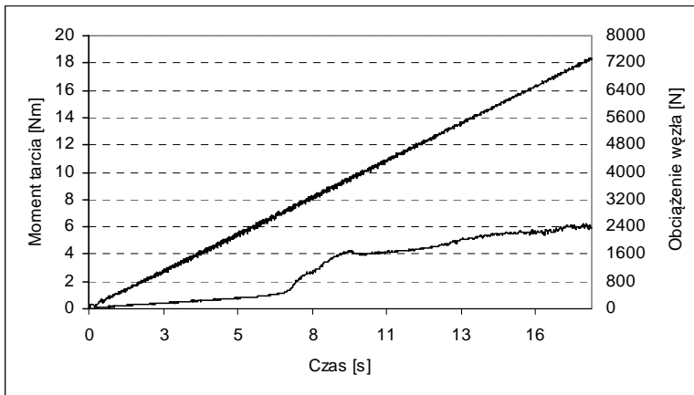
Rys. 6. Przykładowa charakterystyka tribologiczna węzła tarcia smarowanego olejem przekładniowym ( OP )
