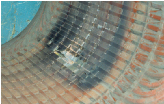
Rys. 13. Wypalone kliny żłobkowe w wyniku zwarć do rdzenia stojana i zwarć zwojowych
