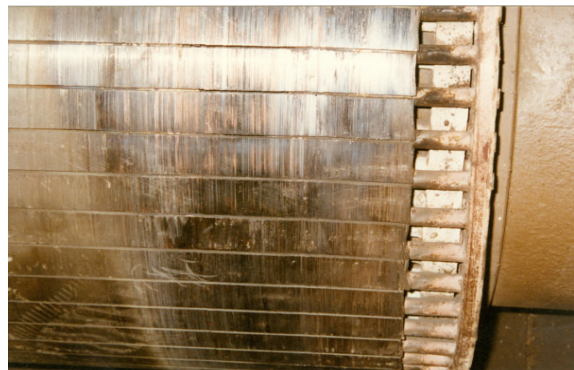
Rys. 10. Zatarcie pakietu blach wirnika
