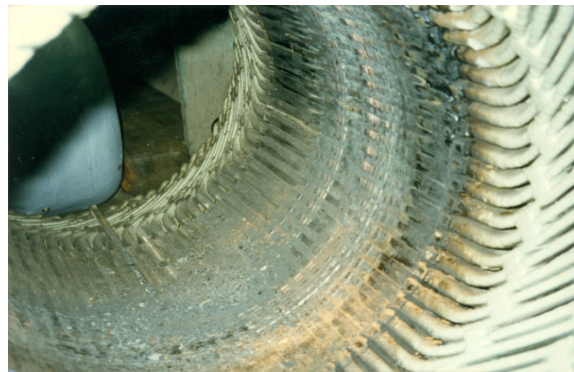
Rys. 9. Zatarcie pakietu blach stojana
