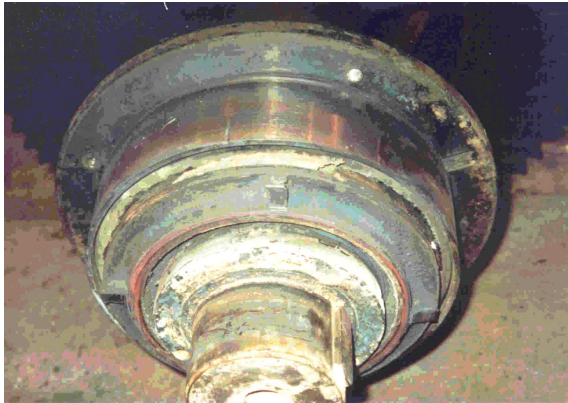
Rys. 5. Uszkodzone łożysko walczkowe
