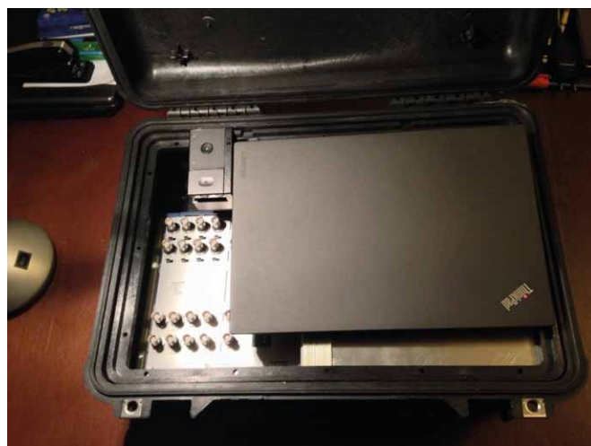
Rys. 6. Waliza ochronna z zabudowanymi elementami systemu w wersji pełnej
