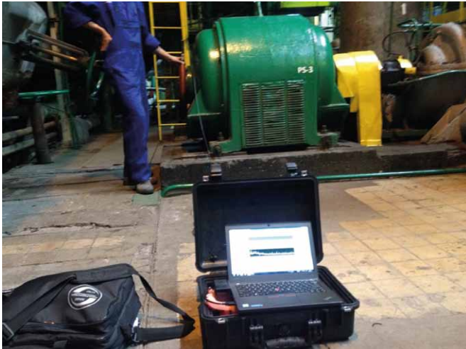
Rys. 9. Widok zestawionego układu pomiarowego podczas badań na stanowisku pracy badanych maszyn
