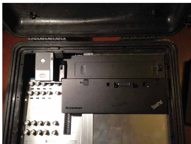
Rys. 7. Waliza ochronna z zabudowanymi elementami systemu w wersji pełnej po wyjęciu komputera przenośnego
