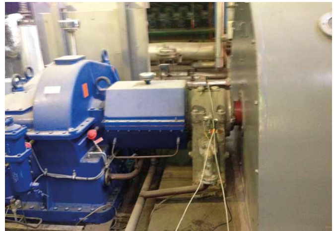
Rys. 17. Widok na miejsce zamontowania akcelerometrów i umieszczenia mikrofonu do badań wibroakustycznych silnika
