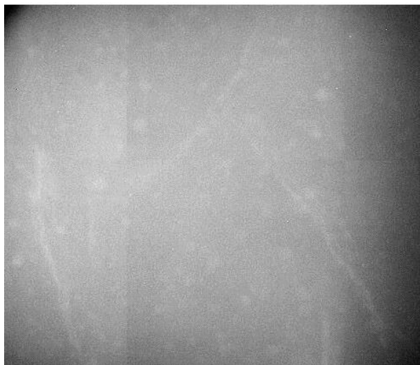
Fot. 11. Pęknięcia ładunku kruszącego materiału wybuchowego
