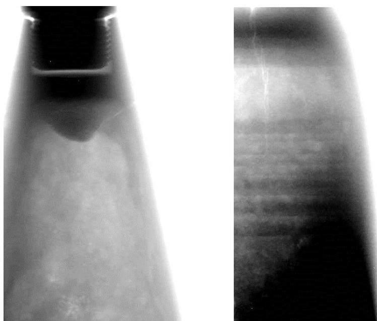
Fot. 6. Fragmenty korpusów pocisków móżdziejowych z widocznymi pęknięciami
