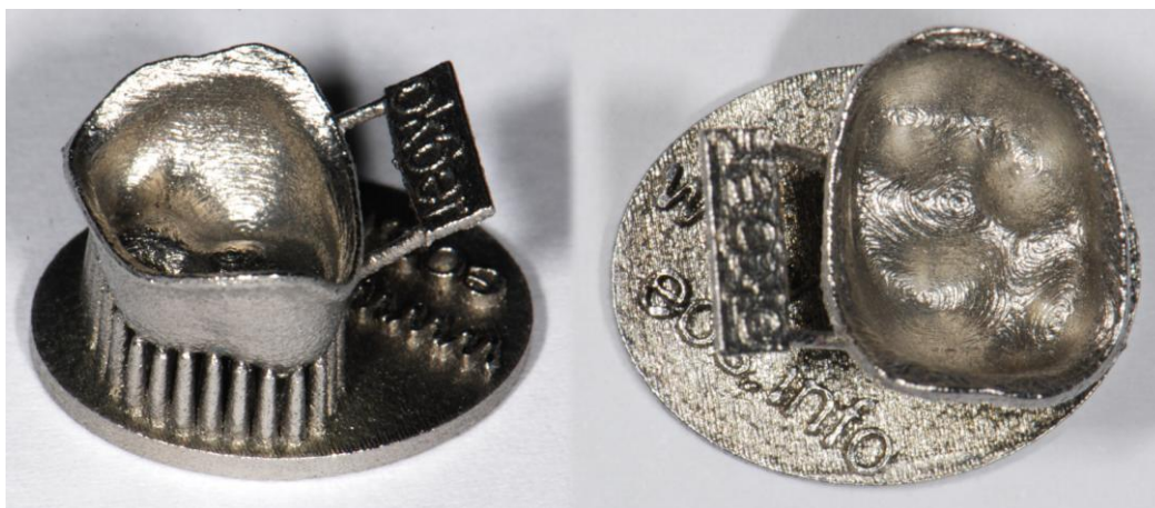
Rys. 9. Podbudowa korony po procesie przyrostowego spiekania laserowego Fig. 9. Substructure crown the incremental process of laser sintering
