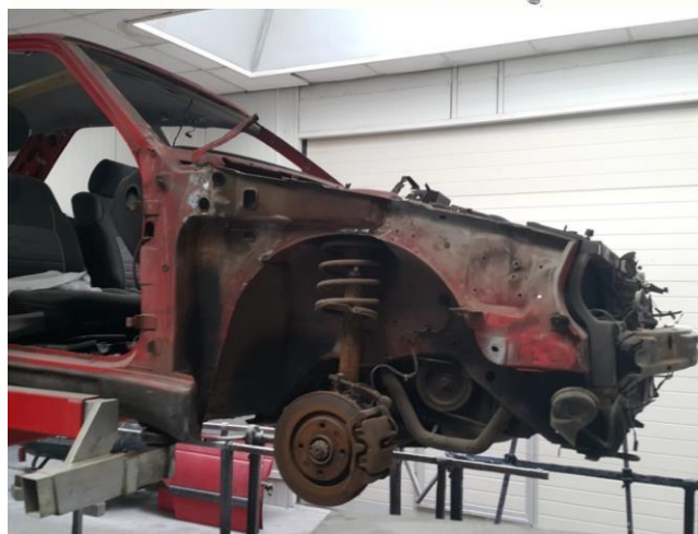
Rys. 3. Schemat szkieletu nadwozia samonośnego współczesnego samochodu osobowego [5], fotografia szkieletu przedniej części nadwozia samochodu osobowego [opracowanie własne]
