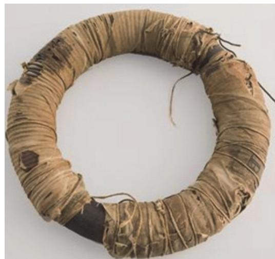
Rys.1. Pierwszy transformator toroidalny wykonany przez Michaela Faradaya, 1831 [7]
