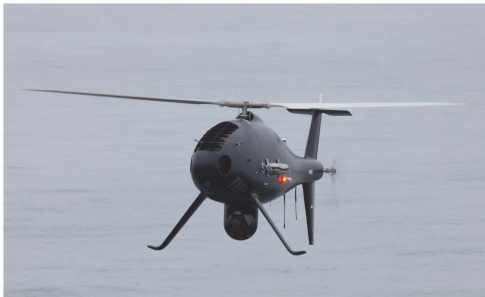
Fot. 5. BSP pionowego startu i lądowania typu CAMCOPTER S-100 firmy Schiebel źródło: http://www.navaldrones.com/images/S-100Dutch.jpg [05.05.2016]
