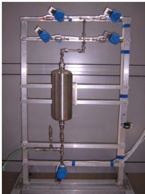
Rys. 2. Nadciśnieniowy układ zasilania nadtlenku wodoru
