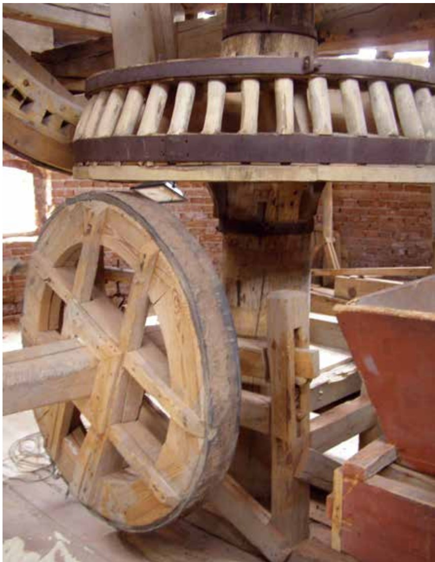
Il. 2. Wiatrak „holenderski” w Pyzdrach, widok wnętrza (II piętro) – pionowy wał napędowy z osadzonym na nim kołem cewiowym, po lewej stronie widoczne koło do napędu windy wiatrakowej; źródło: fot. F. Tomaszewski, 19.07.2019 r.
