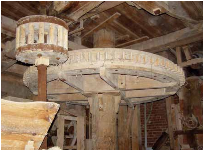
Il. 3. Pionowy wał napędowy wiatraka „holenderskiego” w Pyzdrach z zamocowanym na nim kołem zębatym; po prawej stronie widoczne koło cewiowe napędzające od góry kamień młyński; źródło: fot. F. Tomaszewski, 21.05.2018 r.
