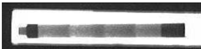
Fot. 4 Zdjęcie RTR opóźniacza pirotechnicznego nasadkowego granatu podwodnego NGP-76.
