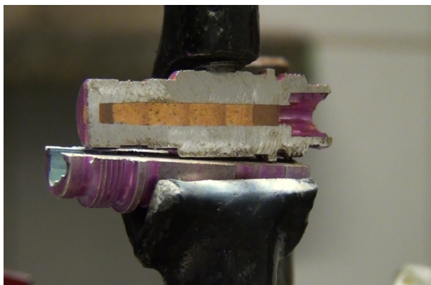
Fot. 5 Próbką badawczą – przecięty wzdłużnie opóźniacz pirotechniczny nasadkowego granatu podwodnego NGP-76, bezpośrednio przed zapłonem za pomocą wiązki laserowej.
