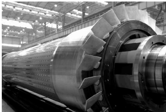
Rys. 4. Nowe wentylatory wirnika turbogeneratora
