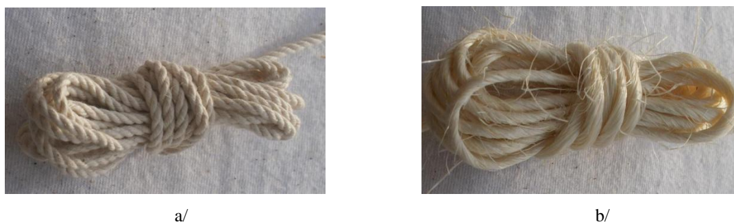
Rys. 2.1. Materiały przeznaczone do wytwarzania oplotu sznurów Kemafil; a/ sznurek bawełniany; b/ sznurek sizalowy
