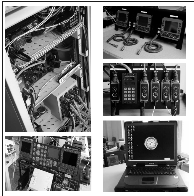
Rys. 2. Widok stanowiska integracyjnego z wybranymi elementami systemu łączności radiowej
