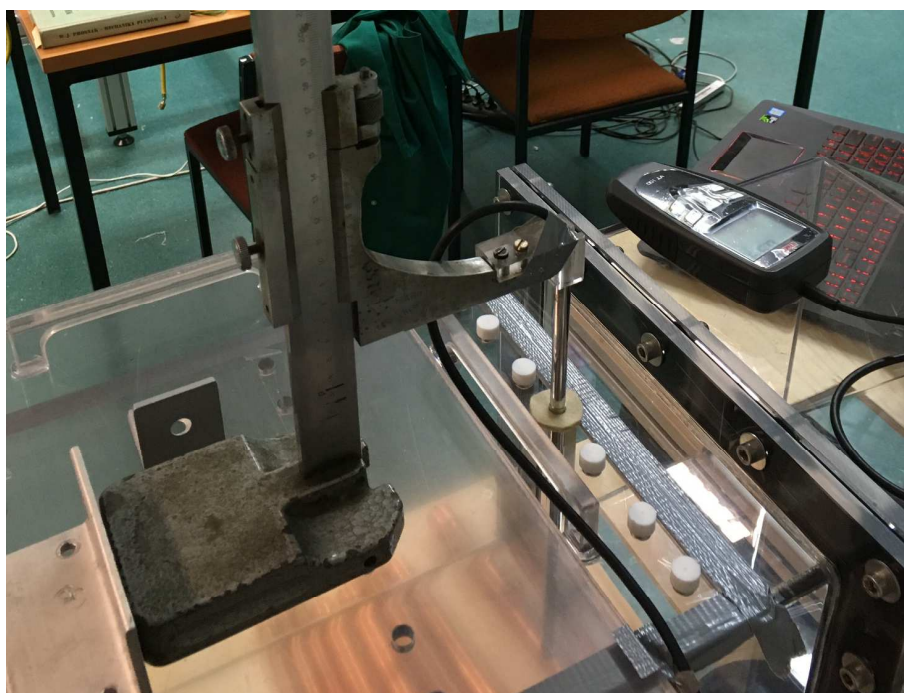
Rys. 7: Uszczelnienie sekcji badawczej w czasie pomiarów prędkości miejscowych
