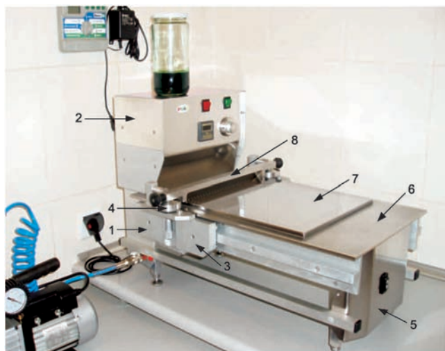
Rysunek 5 Powlekarka do klejów samoprzylepnych – wersja bez czujników cyfrowych (widok boczny)
