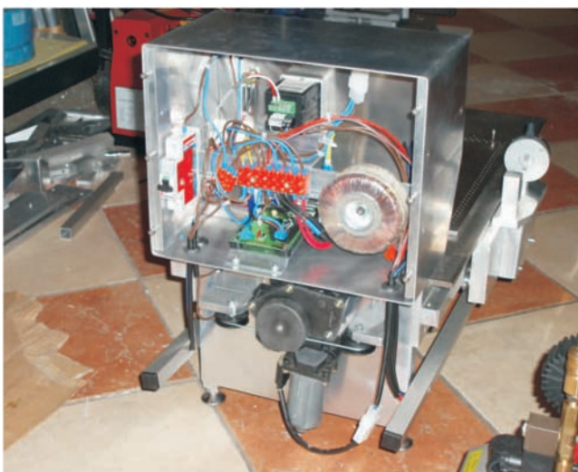
Rysunek 3 Elementy urządzenia zamontowane w obudowanej tylnej części powlekarki
