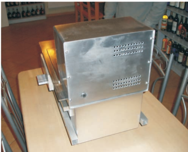
Rysunek 2 Obudowa aluminiowa tylnej części powlekarki
