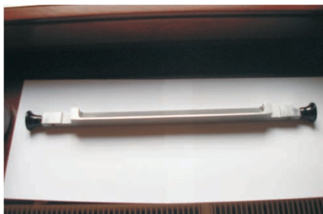
Rysunek 6 Rakiel z polerowanej stali nierdzewnej stosowany do powlekania klejów
