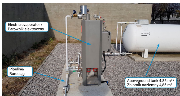
Figure 3. Jet fire test stand including aboveground pressure vessel, electric evaporator, pipeline and gas system safety features Rycina 3. Stanowisko do badania pożarów strumieniowych, w tym naziemny zbiornik ciśnieniowy, parownik elektryczny, rurociąg i zabezpieczenia instalacji gazowej
