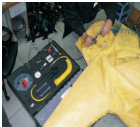
Rys. 6. Napełnianie ubrania Trellech [8]
