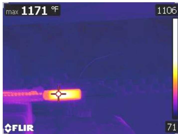
Fot. 2. Przykładowy obraz termiczny części lufy i tłumika broni strzeleckiej po oddaniu serii strzałów (Naval Special Warfare Center, Crane Division)
