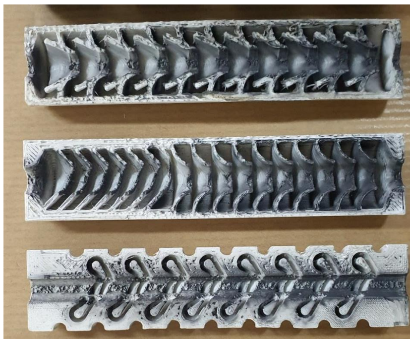
Fot. 3. Wkłady do tłumika wykonane w technologii FDM z materiału PLA (od góry: o stałym kształcie i skoku przegród, o zmiennym kształcie i skoku przegród, z układem zaworów Tesli)
