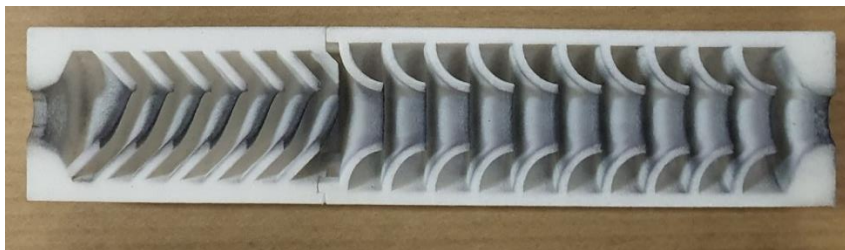
Fot. 4. Wkład do tłumika wykonany w technologii SLS z materiału PA 2200
