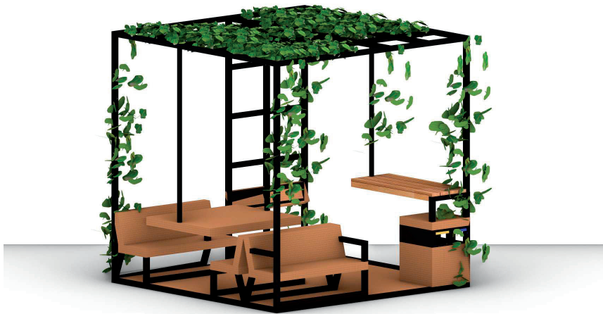
Ryc. 5. Projekt Uni Cube, czyli instalacji zewnętrznej wyposażonej w meble miejskie (ławki z podłokietnikami, stoliki oraz kosz na śmieci), zaprojektowanej na potrzeby społeczności akademickiej Politechniki Śląskiej w Gliwicach zgodnie z zasadami projektowania uniwersalnego. Opracowanie własne
