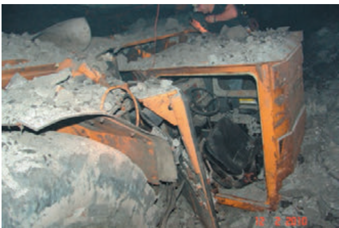
Rys. 7. Kabina operatora oddzielona na skutek uderzenia od ustroju nośnego maszyny
