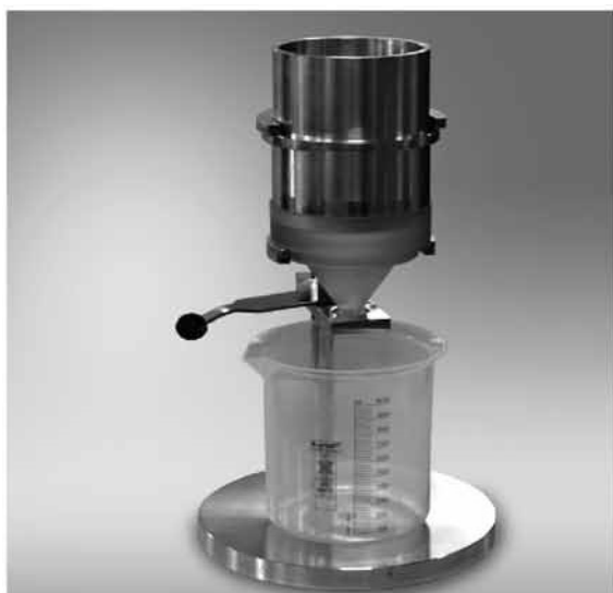
Rys. 1. Urządzenie do przepływu kruszywa drobnego
